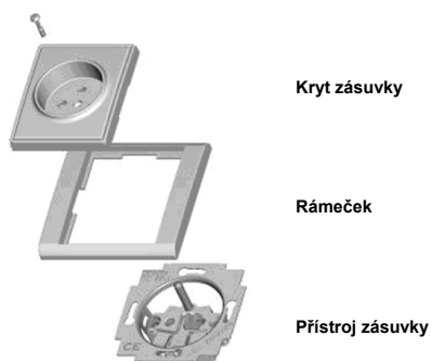
Obr. 5: Sestavování jednonásobné zásuvky s krytem a rámečkem
